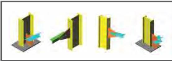
BRACING CONNECTION - CHANNEL BRACING
