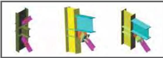
SHEAR CONNECTION - BEAM TO BEAM
